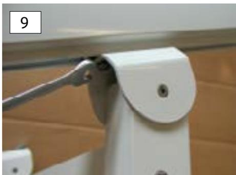
Unter Zuhilfenahme eines 13mm Ring/Maulschlüssels an beiden Seiten (oben/unten) der Aufnahme die Führungsschiene festschrauben.
